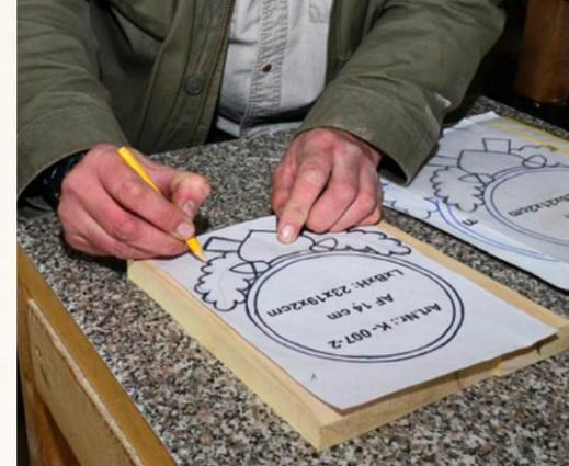
Mit dem Bleistift werden die Konturen übertragen (o.), die im Anschluss ans Aussägen fein ausgearbeitet werden (u.).
